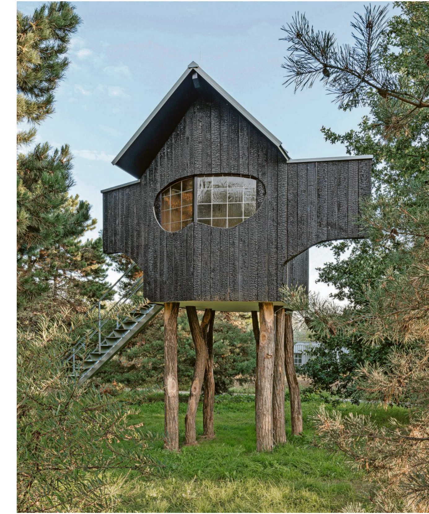
Wohnt hier Fred Feuerstein? Die Fassadenbretter seines Teehauses hat Terunobu Fujimori händisch geflammt. Foto Hertha Hurmas
